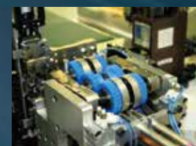
2線式機構 (両端圧着: 7,200本/時、 片端防水圧着: 4,500本/時) 2 线式机构 (両端圧着7,200根/小时、 防水栓插入圧着: 4,500 根 / 小时) Dual feed system (Both-ends crimping: 7,200pcs/h, Single-end WP seal crimping: 4,500pcs/h)
